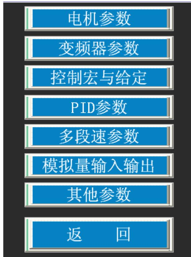
参数设置包括电机参数、变频器参数、控制与给定参数、PID 参数、多段速参数、模拟量输入输出和其他参数选项。
