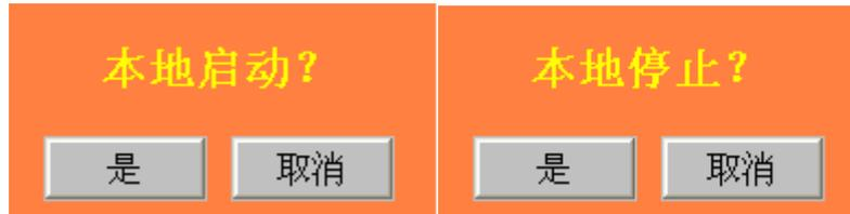
本地停止：点击 HMI 上停止按钮或按柜门上停止按钮停止。HMI 会有确认停止提示，如上图所示。
