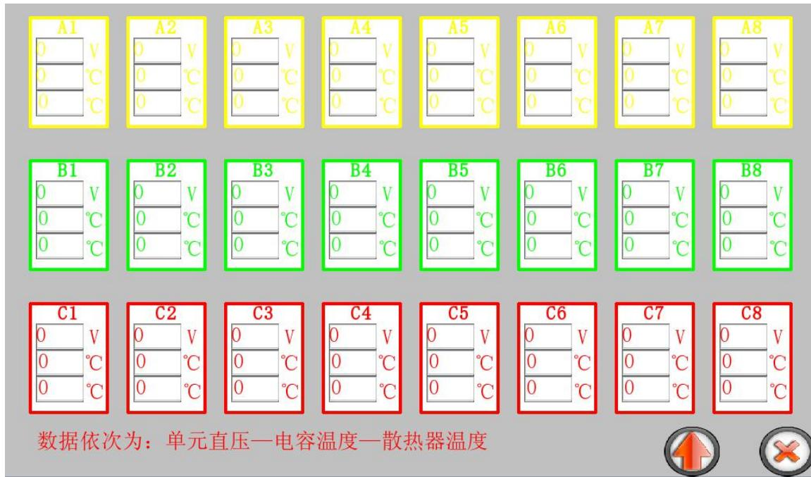
变频器功率单元在高压上电之后，触摸屏单元数据页面能实时显示所有单元的母线电压、电容温度、散热器温度信息。
